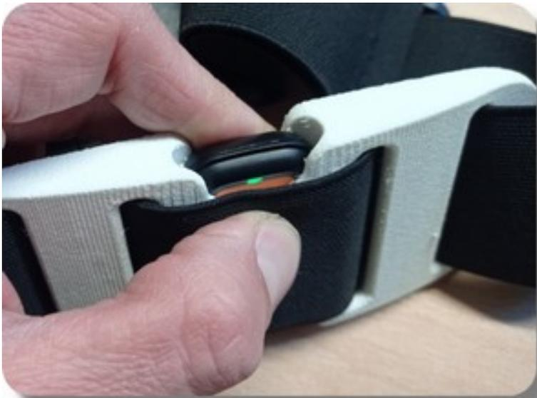
La muesca en el soporte indica dónde se encuentra el botón de encendido del sensor. Al presionar sobre ese punto durante unos segundos se enciende el sensor y su indicador LED comienza a parpadear.
