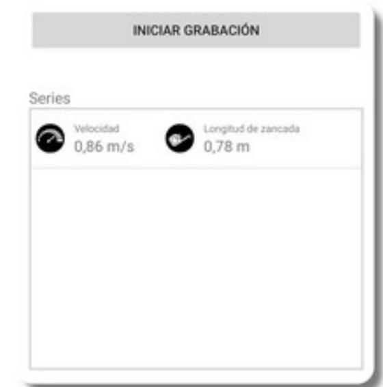
En caso de utilizar un único sensor colocado en la espalda, es necesario indicar el paso por marcas en el suelo separadas por la distancia prefijada en la configuración. De esta manera es posible calcular la velocidad media de la marcha.
