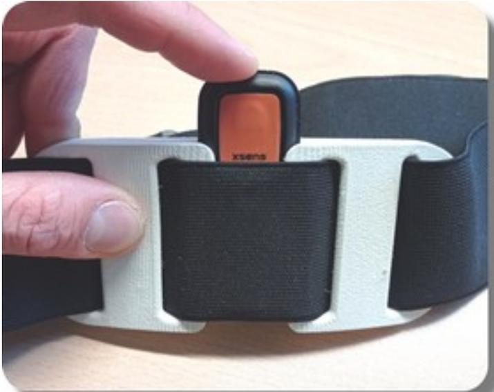
Los sensores (unidades inerciales Xsens DOT) se insertan en los soportes proporcionados tal como se indica en la imagen.
